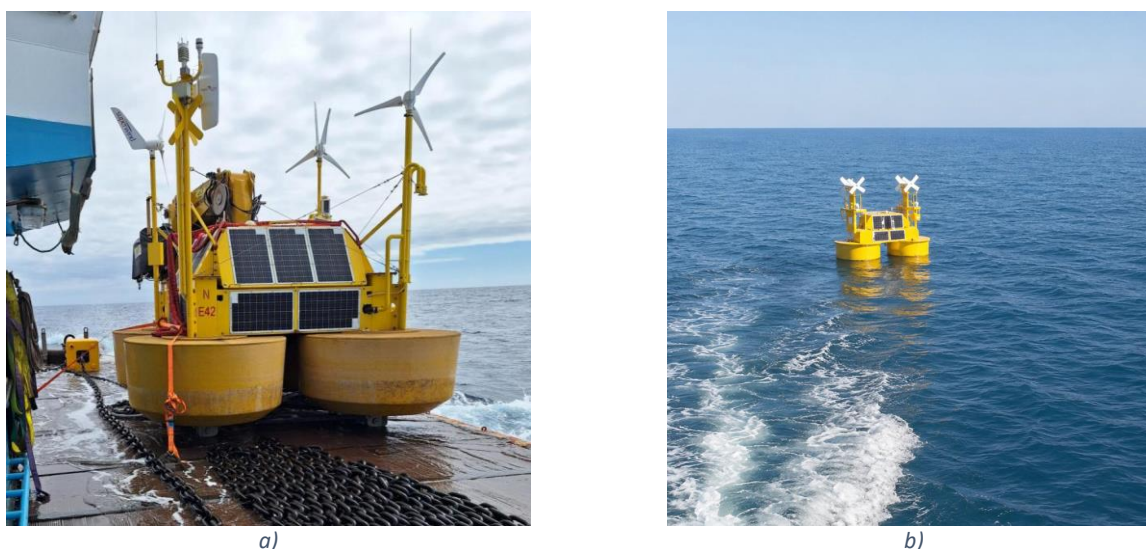
Figura 4.4. Fotografias do FLS LO1 - Viana do Castelo: a) transporte do equipamento e b) após instalação no local.
