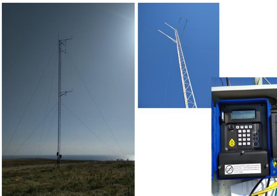
Figura 4.11. Fotografias do mastro anemométrico Met2 – BE instalado na Ilha da Berlenga.
